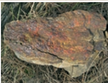
Mostres d'hematites extretes d'un del filons existents en una de les galeries, és de poca qualitat ja que es tracta d'una crosta d'uns tres mil·límetres de gruix que recobreix una matriu.
