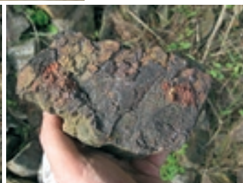
Mostres d'hematites extretes d'un del filons existents en una de les galeries, és de poca qualitat ja que es tracta d'una crosta d'uns tres mil·límetres de gruix que recobreix una matriu.
